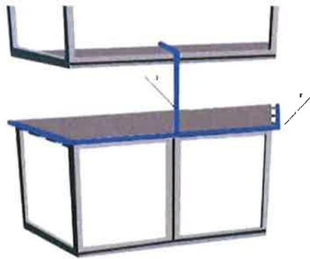
图 D.0.1 外门窗及其周边墙面淋水示意图
